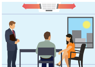
Nepřímý tok vzduchu při detekci pohybu
